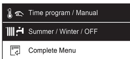
2 Les boutons « + » et « - » sont utilisés pour sélectionner le jeu de paramètres et apporter des modifications aux paramètres individuels. Le bouton **OK** permet de sélectionner le jeu de paramètres, de confirmer et de stocker tous les ajustements effectués.
