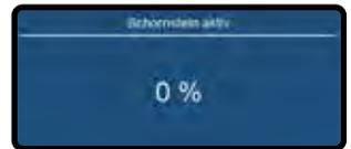
Der O<sub>2</sub>-Wert in der Kleinlast muss immer höher liegen als der O<sub>2</sub>-Wert in der Volllast. Die Messung muss so lange durchgeführt werden, bis sich ein konstantes Messergebnis eingestellt hat. Sollten die O<sub>2</sub>-/CO<sub>2</sub>-Werte außerhalb der Toleranzen der Tabelle liegen, passen Sie bitte den O<sub>2</sub>-/CO<sub>2</sub>-Wert an (siehe Schritt 3 auf Seite 70).
