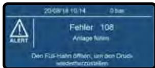
3. Das automatische Entlüftungsprogramm von 7 Minuten startet ab einem Wasserdruck von 1,3 bar.
