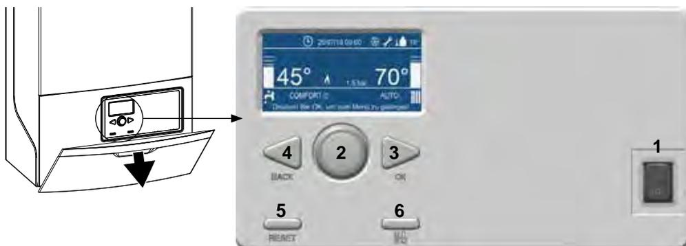
Nach dem Öffnen der Blende wird ein Aufkleber mit den Grundfunktionen der Bedienungselemente sichtbar, welche mit den folgenden Abbildungen näher erläutert werden.
