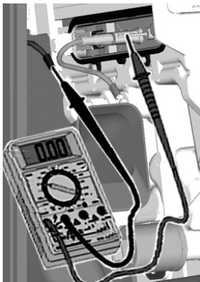
Messung des Ionisationsstromes Bild 11.3.f
