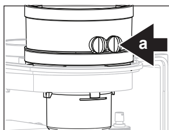
Messpunkt Abgassonde Bild 9.5.a
