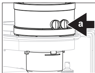
Messpunkt Abgassonde Bild 10.5.a
