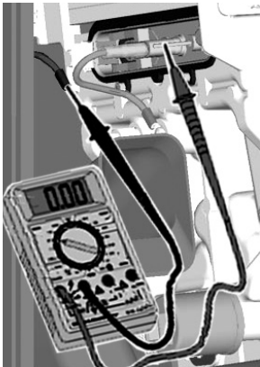
Messung des Ionisationsstromes Bild 11.3.f
