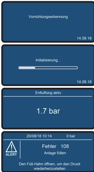
3. Das automatische Entlüftungsprogramm von 7 Minuten startet ab einem Wasserdruck von 1,3 bar.
