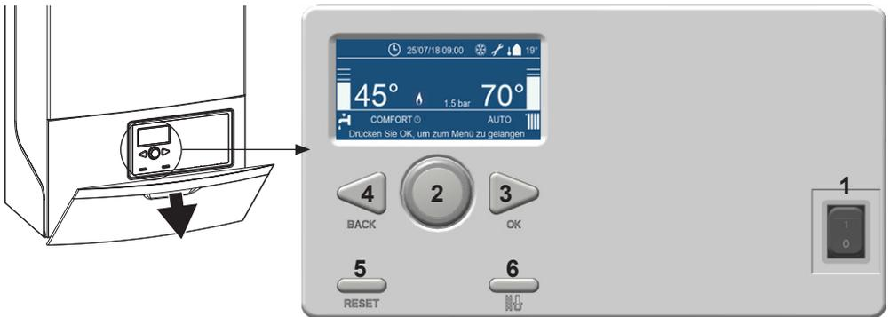
Nach dem Öffnen der Blende wird ein Aufkleber mit den Grundfunktionen der Bedienelemente sichtbar, welche mit den folgenden Abbildungen näher erläutert werden.
