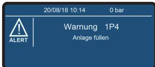
Sinkt der Wasserdruck unter 1,0 bar, wird im Bildschirm "Warnung 1P4" angezeigt. Sollte der Wasserdruck unter 0,7 bar gelegen haben, so startet nach Auffüllen das automatische Entlüftungsprogramm.
