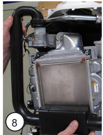
8. Entfernen Sie den Luftzufuhrdämpfer;
