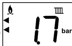
Normal-Anzeige mit Kessel in Betrieb für Heizung
