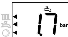
Standaard staat de ketel ingesteld, dat de pomp bij warmtevraag voor cv of ww inschakelt. Het in- en uitschakelen wordt geheel door de regeling gestuurd.
