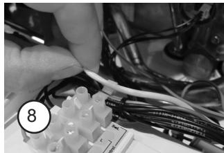
7 Verwijder van de achterzijde van de stuurautomaat alle stekkers;
