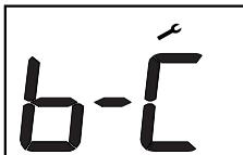
Bij niet aangesloten buitenvoeler wordt enkele seconden Err 114 getoond, voordat b-C verschijnt.
