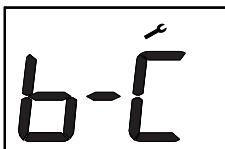
Si la sonde extérieure n'est pas connectée, Err 114 est affiché pendant quelques secondes, avant que b-C n'apparaisse.
