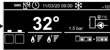
10. Quindi viene automaticamente eseguito il reset della caldaia e lo schermo mostra nuovamente la procedura di start-up:
