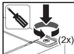
在对锅炉进行操作后，一定要把面板装回，用2个螺丝拧紧。
