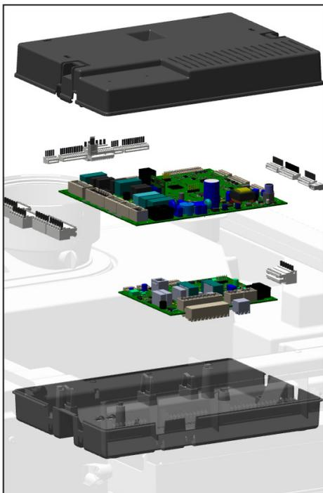
5. Verwijder alle stekkers van de printplaat en verwijder de printplaat. Indien de SLAVE-stuurautomaat vervangen moet worden, verwijder dan ook van de onderste printplaat alle stekkers en verwijder de printplaat.
