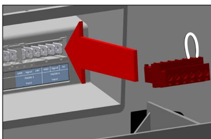
**! LET OP:** Indien een nieuwe Master printplaat geplaatst wordt in een ketel van vóór 2021 (tot P210450459, zie typeplaat) houdt rekening met het volgende: **Neem de connector met de brug (deel van leveringsomvang) en plaats deze op aansluiting PADIN 4 (niet indien hier BOILER LOCK staat).**
