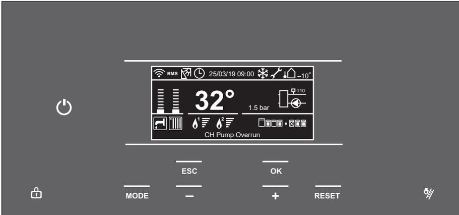
7. Schakel de voedingsspanning weer in; Wanneer een ketel wordt geactiveerd, verschijnt een vraag zoals in de afbeelding. Nadat u op OK drukt, verschijnt het volgende menu.
