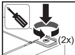
**Dopo aver lavorato sulla caldaia, rimettere sempre in posizione la copertura e fissarlo serrando le 2 viti.**
