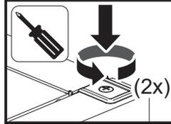
**Nach Abschluss der Arbeiten am Kessel immer die Haube montieren und mit den Schrauben befestigen.**
