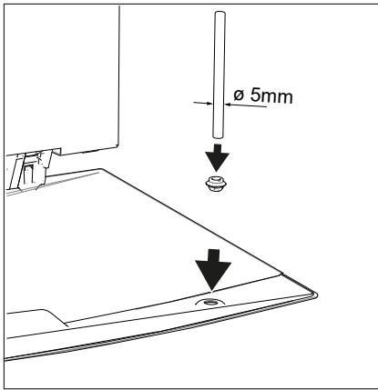
Druk de kunststof magneethouder op zijn plaats, met behulp van een cilindrisch stomp voorwerp, bijvoorbeeld met de achterzijde van een boortje Ø 5 mm.
