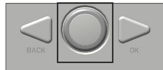
Der Feuerungskontrollautomat hat einen "Sleepmodus", wenn innerhalb einer bestimmten Zeit keine Taste betätigt wird. Die Aktivierung erfolgt durch eine beliebige Tastenbetätigung.
