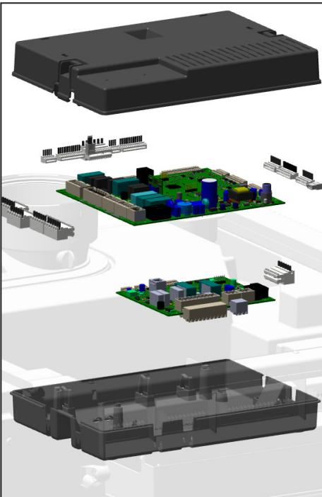
5. Verwijder alle stekkers van de printplaat en verwijder de printplaat. Indien de SLAVE-stuurautomaat vervangen moet worden, verwijder dan ook van de onderste printplaat alle stekkers en verwijder de printplaat.
