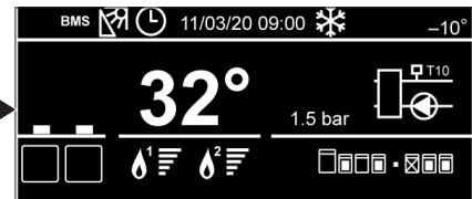
10. Quindi viene automaticamente eseguito il reset della caldaia e lo schermo mostra nuovamente la procedura di start-up:
