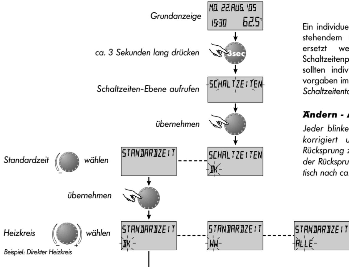
Ein individuell erstelltes Schaltzeitenprogramm kann gemäß nebenstehendem Programmierschema durch sein Standardprogramm ersetzt werden. Hierbei wird das individuell erstellte Schaltzeitenprogramm jedoch unwiederbringlich gelöscht. Deshalb sollten individuelle Ein- und Ausschaltzeiten sowie Temperaturvorgaben immer schriftlich vermerkt werden (siehe *SCHALTZEITEN - Schaltzeitentabelle für eigene Schaltzeiten*).
