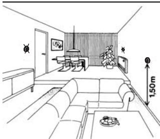
Installation • Instalación • Installation • Installatie • Installation • Szerelés • Instalace • Montaż • Inštalácia • Instalare • Kurulum
