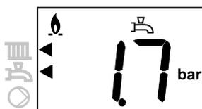
Het WW-programma is na opstart altijd actief. Dit wordt aangegeven door de middelste
